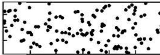
Рисунок А.8 — 8 % поверхности, 122 поры,  $d = 1$  мм
