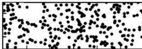
Рисунок А.9 — 16 % поверхности, 244 поры,  $d = 1$  мм
