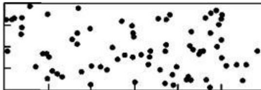
Рисунок А.7 — 5 % поверхности, 76 пор,  $d = 1$  мм
