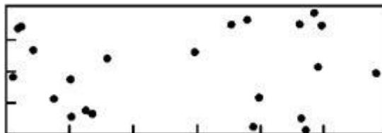
Рисунок А.2 — 1,5 % поверхности, 23 поры,  $d = 1$  мм
