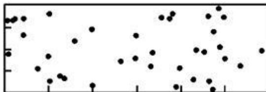
Рисунок А.4 — 2,5 % поверхности, 38 пор,  $d = 1$  мм
