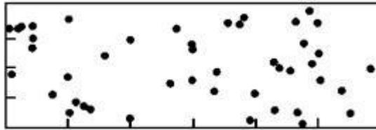
Рисунок А.5 — 3 % поверхности, 45 пор,  $d = 1$  мм
