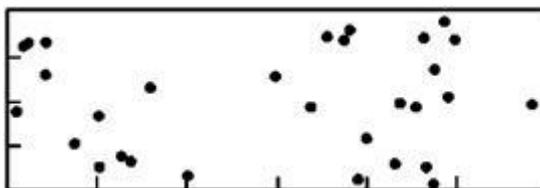
Рисунок А.3 — 2 % поверхности, 30 пор,  $d = 1$  мм
