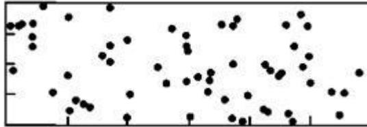
Рисунок А.6 — 4 % поверхности, 61 пора,  $d = 1$  мм
