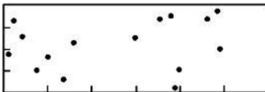
Рисунок А.1 — 1 % поверхности, 15 пор,  $d = 1$  мм
